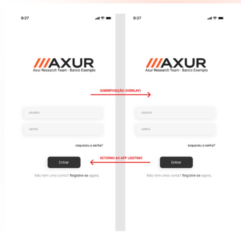
**Figura 2:** Una superposición creada por Sharkbot permite capturar credenciales mientras se ejecuta una aplicación legítima.
